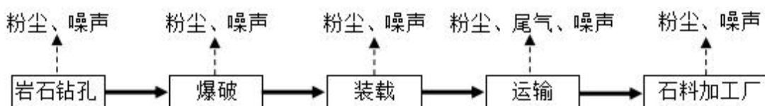
图4 矿石采装生产流程及产污环节图
