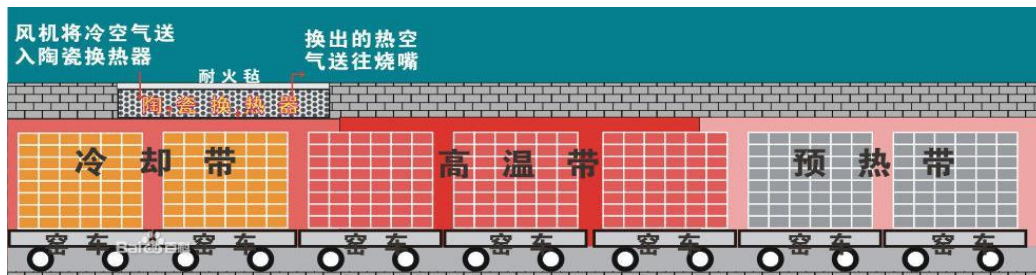
图7 焙烧窑工作原理图
